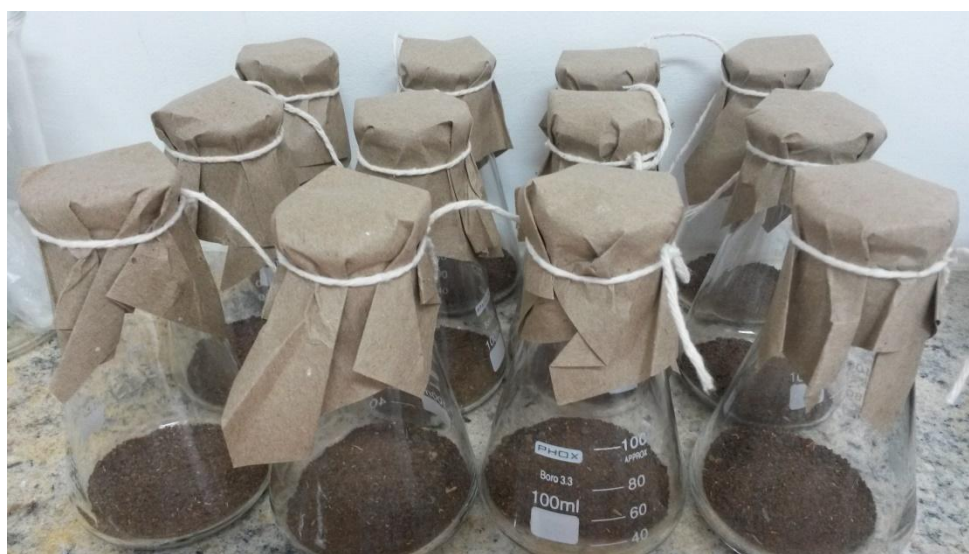
Figura 4: Fermentação em estado sólido do fungo Pencicillium roqueforti em resíduo de cacau tratado. Fonte: autora
