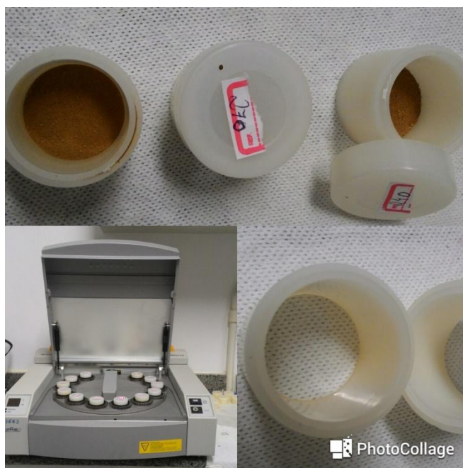
Figura 5 Recipiente com película de polipropileno, altura de 2,85 cm e diâmetros de 2,78 cm (interno) e 3,44 cm (externo) apropriado para análise por EDXRF, o recipiente com solo e o espectrômetro
